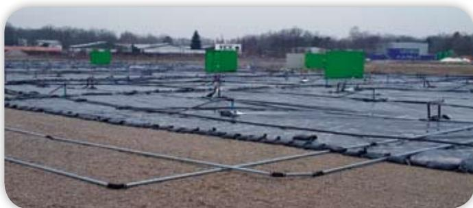
Técnica de descontaminação “Air Sparging”.
